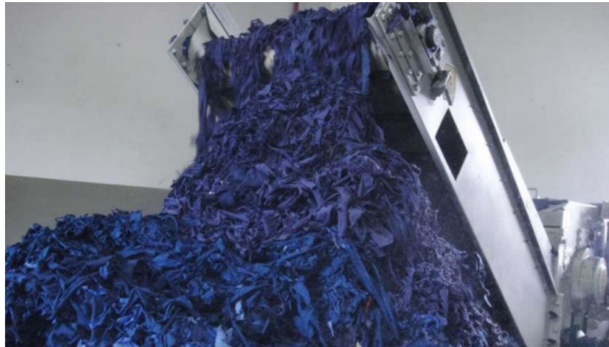
Figura 9 - Processo de trituração dos tecidos separados por cor
