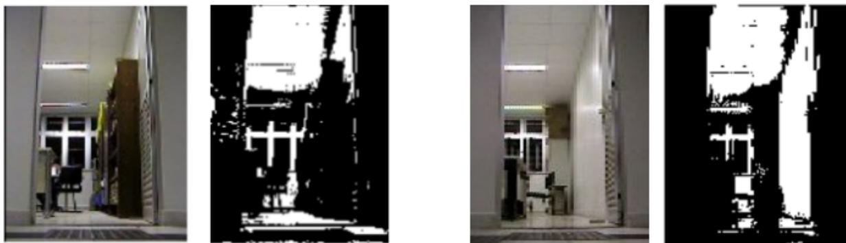
Figura 3.25: Portas abertas no período da noite e aplicação do *thresholding*. Fonte: o autor.
