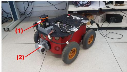
Figura 3.2: Robô Pioneer 3-AT utilizado no estudo de caso instalado com (1) sensor de distância a laser e (2) câmera. Internamente, ainda existe o sensor de posição e velocidade das rodas, encoder, acessível por meio de sua odometria. Fonte: O autor.
