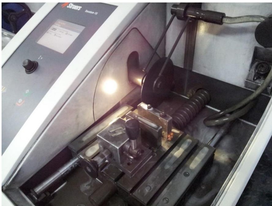
Figura 3.3. Cut-off de precisão utilizada para cortar a amostra para análise de segregação.
