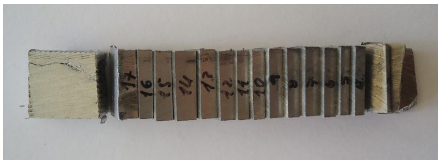
Figura 3.4. Amostra do centro do lingote da liga Al-8,5%Ni para análise de segregação.
