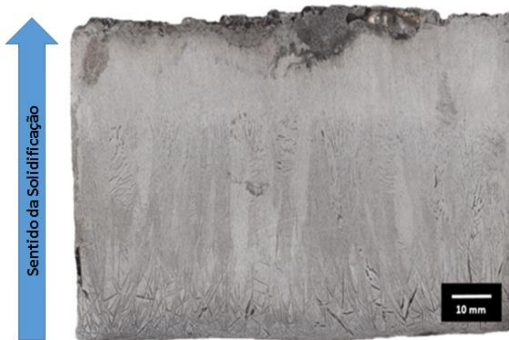
Figura 4.1. Macroestrutura da fatia central do lingote da liga Al-8,5%Ni.
