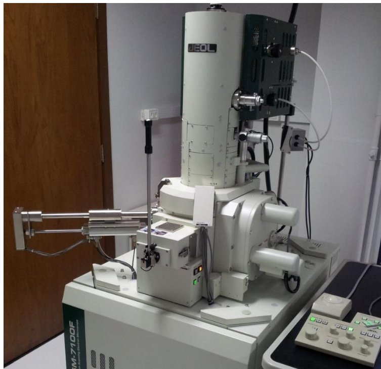
Figura 3.7. Microscópio eletrônico de varredura (MEV) utilizado na caracterização da microsegregação.
