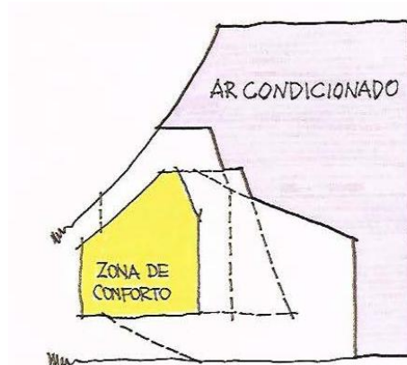
Fig. 2.13 – Zona de ar-condicionado (LAMBERTS, 1997)
