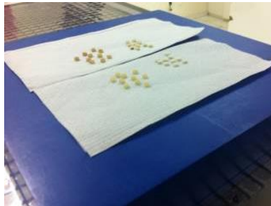
Figura 13 – Corpos de prova dispostos lado a lado sobre folha de toalha absorvente na área de radiação
