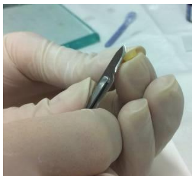
Figura 11 – Acabamento de bordas do corpo de prova com lâmina de bisturi nº 15
