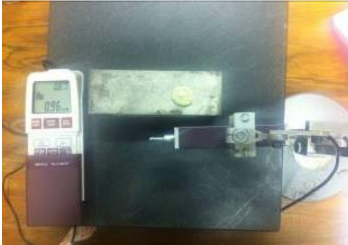
Figura 2 - Rugosímetro (Mitutoyo, modelo SJ-201, Japão)
