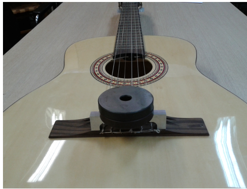
Figura 17: Medição da rigidez elástica do tampo do violão
