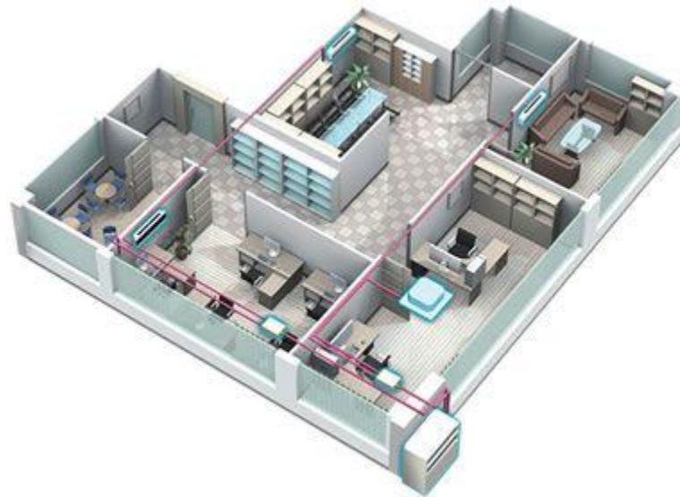
Figura 2.4-3 Sistema multi-split diversos ambientes, website delfrigenarcondicionado
