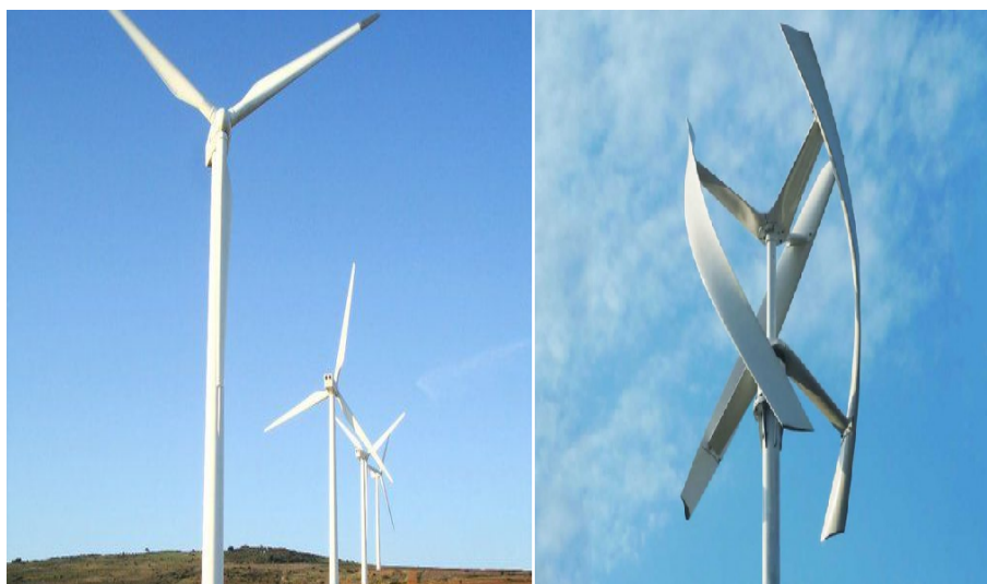
Figura 2.1: Turbinas com eixo horizontal (à esquerda) e vertical (à direita)
