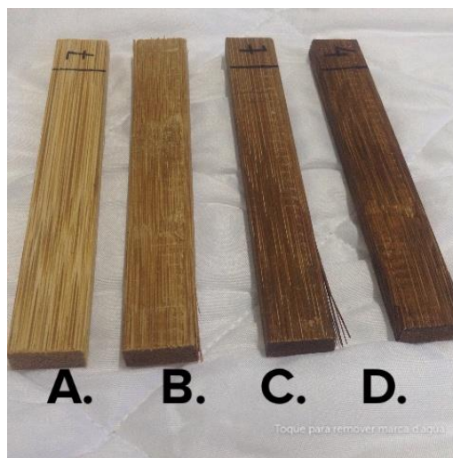
Figura 5: Taliscas após o tratamento térmico, onde: A: 150 °C/ 2 horas; B: 150 °C/ 4 horas; C: 180 °C/ 2 horas e D: 180 °C/ 4 horas.
