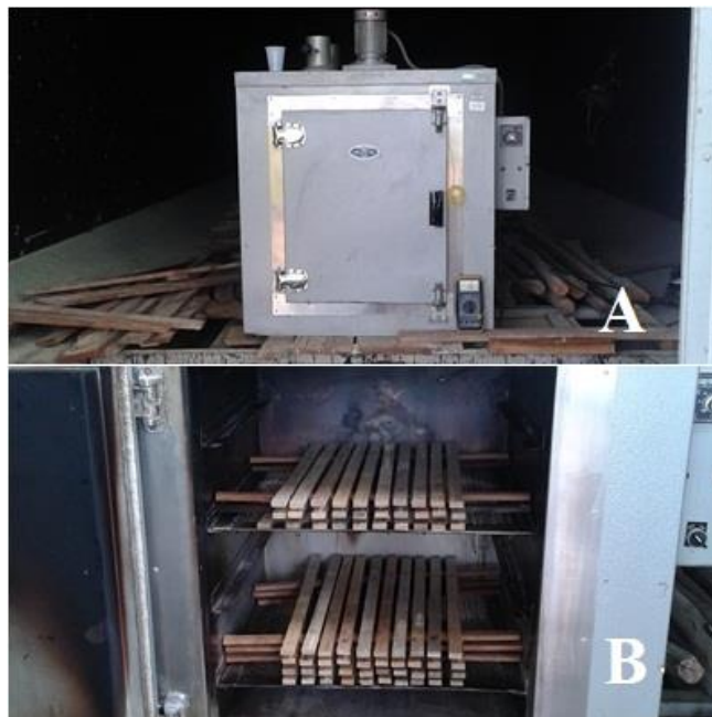
Figura 4: A= Estufa utilizada no tratamento térmico; B= Taliscas no interior da estufa.
