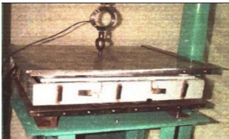
Figura 8 – Plataforma de força de Roesler sendo calibrada.
