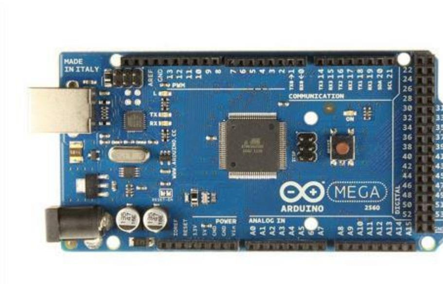
Figura 18 - Arduino Mega 2560
