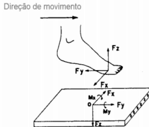
Figura 4 - Plataforma de força com as usa devidas componentes de força e momento  $F_z$  (força normal),  $F_x$  (força médio lateral),  $F_y$  (força antero posterior),  $M_x$  (momento em torno do eixo X) e  $M_y$  (momento em torno do eixo Y)
