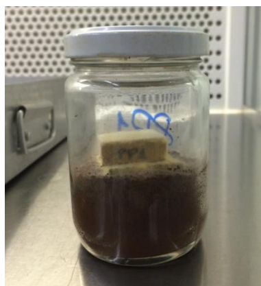
Figura 2 - Corpo de prova sobre a placa suporte, inoculada com o fungo Gloeophyllum striatum .
