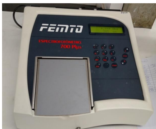
Figura 8 - Espectrofotômetro UV calibrado com absorvância de 205 mm utilizado na obtenção da lignina ácido solúvel.
