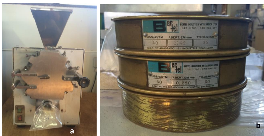
Figura 4 - Moinho do tipo Wiley utilizado para reduzir os corpos de prova (a) e peneiras para classificação granulométrica utilizada para separar as partículas entre 40 e 60 mesh (b).
