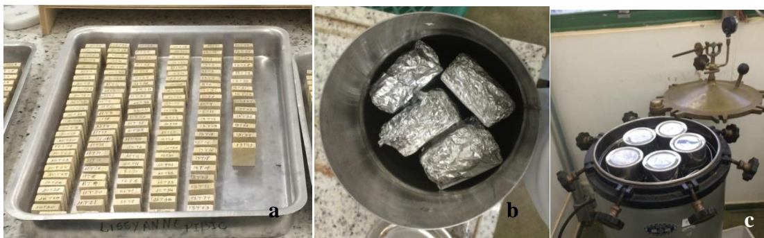
Figura 1 - Corpos de prova dispostos em bandeja de alumínio prontos para climatização em estufa (a); corpos de prova embalados em papel alumínio e levados a autoclave (b, c).
