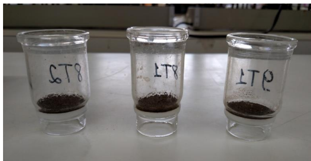
Figura 7 - Cadinho filtrante de porosidade fina com material lignocelulósico insolúvel, prontos para serem levados a estufa
