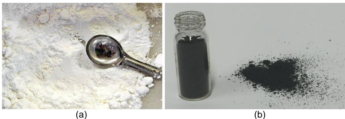
Figura 18. Imagem do gluconato de potássio antes (a) 93 e após o procedimento de pirólise (b).
