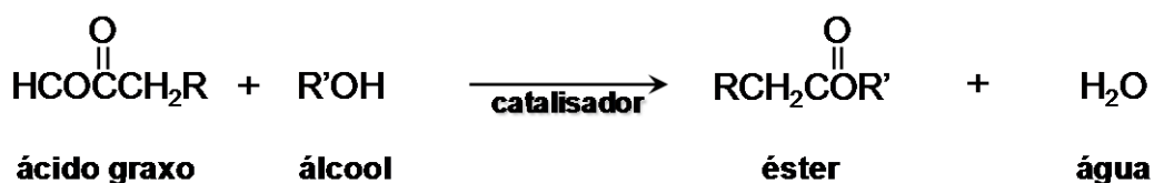
Figura 4. Reação de esterificação de um AGL com uma molécula de álcool (relação estequiométrica), formando um éster de alquila e água.
