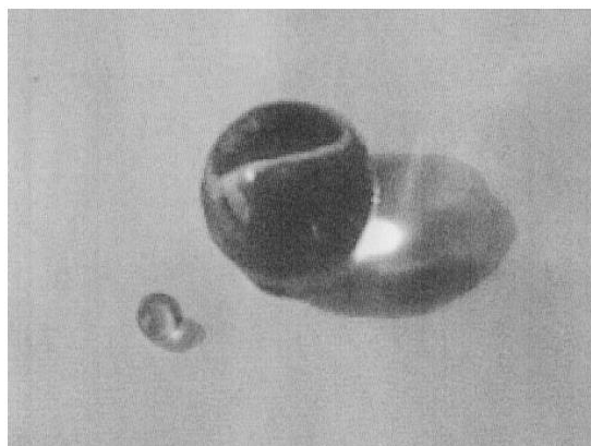
Figura 2.12 – Comparação entre partículas de PSA no estado seco e no estado expandido, pós absorção. (JENSEN e HANSEN, 2001).
