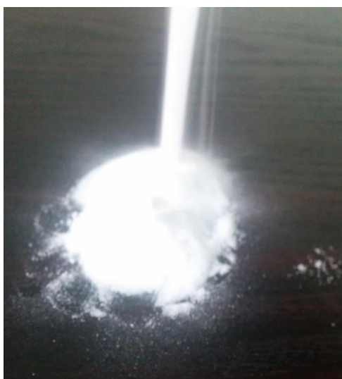
Figura 3.1 – Polímero superabsorvente cedido por JENSEN, estado seco.
