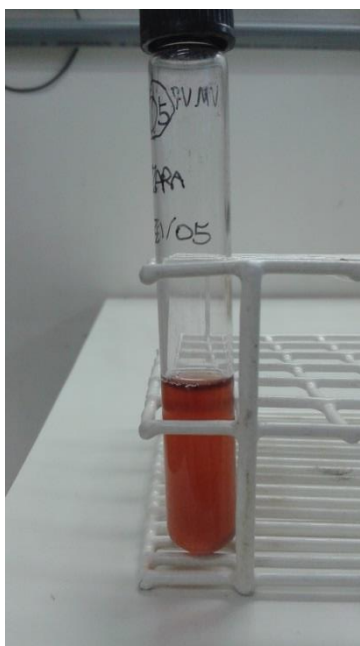
Figura 28: Teste de VP® positivo, com cor avermelhada após de se ter adicionado as soluções e deixar reagir com o ar atmosférico por cerca de 15 minutos. Fonte: Acervo pessoal.
