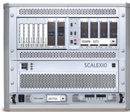
Figura 6 – Exemplo de uma plataforma Hardware in the Loop SCALEXIO da dSPACE. Fonte: (WALTER, 2014)
