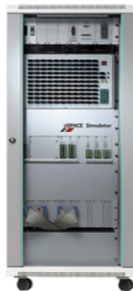
Figura 5 – Exemplo de típico Hardware in the Loop comercial da dSPACE. Fonte: (PALADINO; FIENGO; LANZO, 2012)
