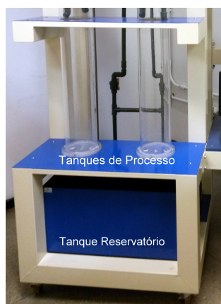
Figura 2.6: Tanques Reservatório e de Processo
