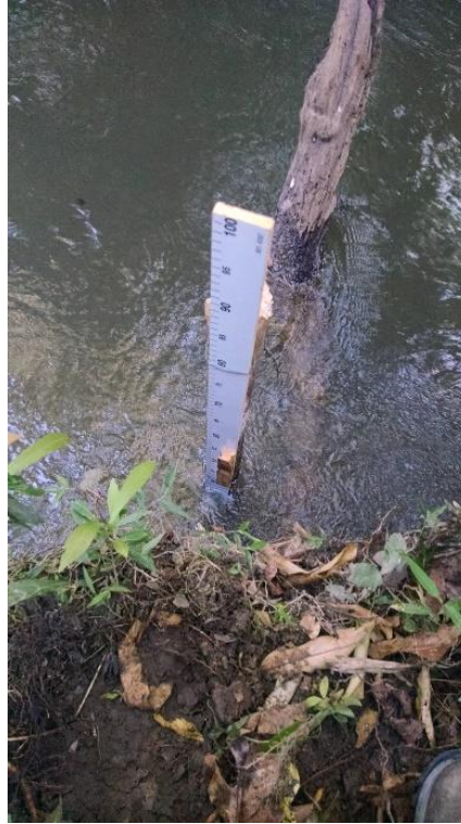
Figura 11 Régua usada para o monitoramento do nível.
