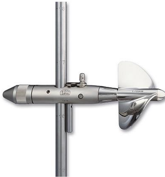
Figura 9 Foto molinete hidrométrico (Fonte: hidromechc).
