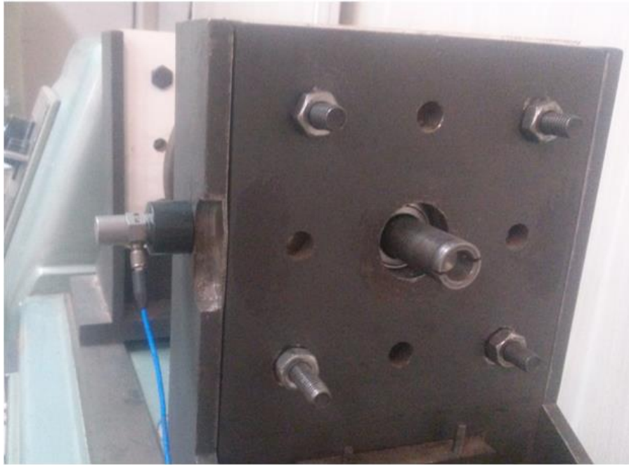
Figura 50. Posicionamento do acelerômetro na bancada
