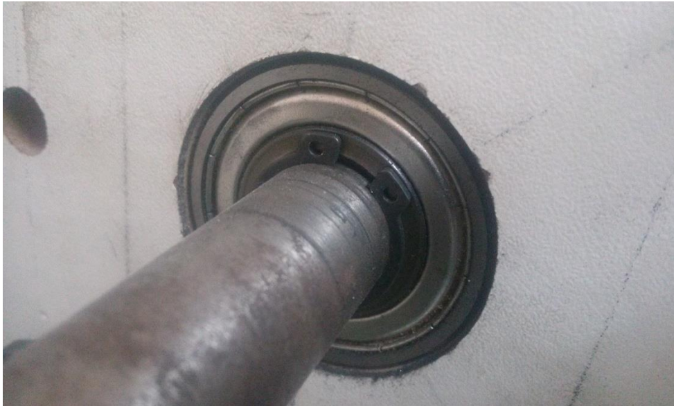
Figura 48. Posicionamento do anel elástico na montagem
