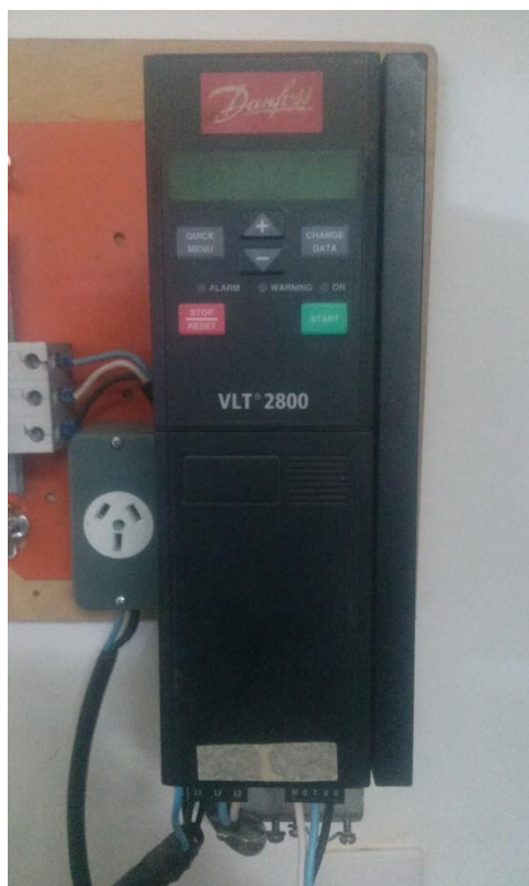
Figura 47. Inversor de frequências VLT 2800 (Fabricante: Danfoss)
