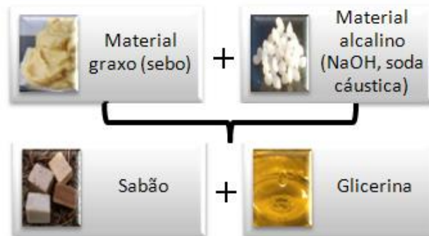
Figura 3 – Esquema da produção básica do sabão e glicerina. (Fogaça, 2017)
