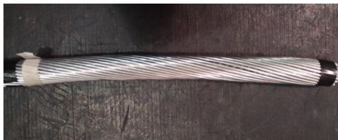
Figura 4.4 – Pedaço cortado do cabo IBIS
