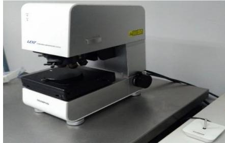
Figura 4.3 - Microscópio Confocal Olympus LEXT OST 4100
