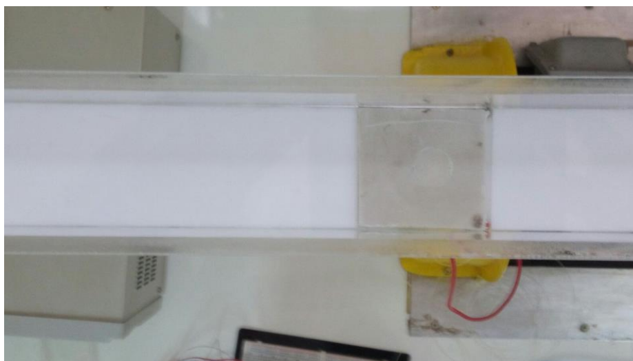
Figura 19 - Detalhes da célula encaixada na seção de testes, com passagens para os fios
