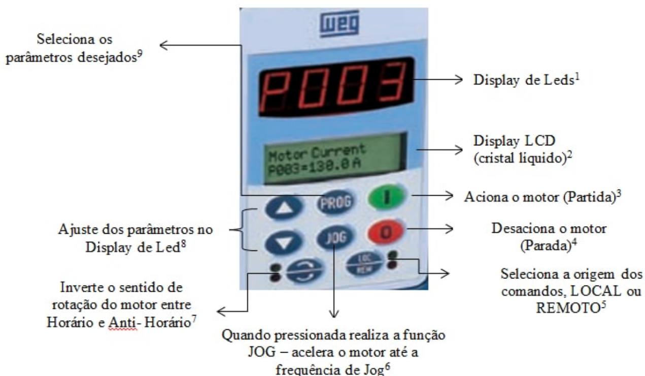
Figura 7 – Descrição da Interface do Soft-Starter composto por elementos determinantes para o funcionamento adequado do equipamento. Dentre os elementos, os principais para a realização dos experimentos são: o Display de Leds (programação dos parâmetros), o Display de LCD (mostra o conteúdo dos parâmetros programados), (I) momento em que o motor começará a girar de forma gradativa, e (0) essa tecla tem como função o regresso da velocidade do motor até o momento de estacionar; PROG (selecionar os parâmetros e valores desejados) e, outra tecla de suma importância, é o ajuste de parâmetros que, a partir dela, serão estabelecidos os parâmetros e valores desejados pelo usuário (WEG, 2009)
