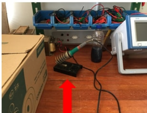
Figura 11 – A solda metálica é um risco químico de grau pequeno, gera fumos metálicos através do aparelho de solda, gerando desconforto através da respiração ao usuário. Fonte: A autora
