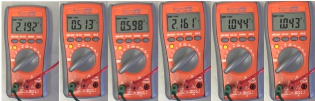
Figura 52 – Medição da corrente no tempo de 1 a 13 segundo. Na imagem, com a amperagem de 2,192, ocorre o momento da partida em estrela. Após oito segundos, a configuração estrela sofre uma comutação para delta e sua corrente se eleva para 2,161. Depois, estabiliza-se próximo à corrente nominal.
