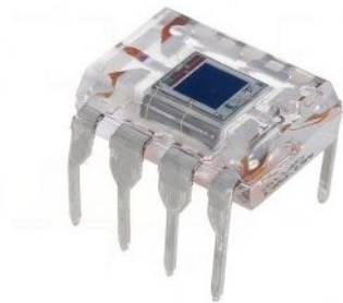
(a) Fotodiodo OPT101 com amplificador de transimpedância.
