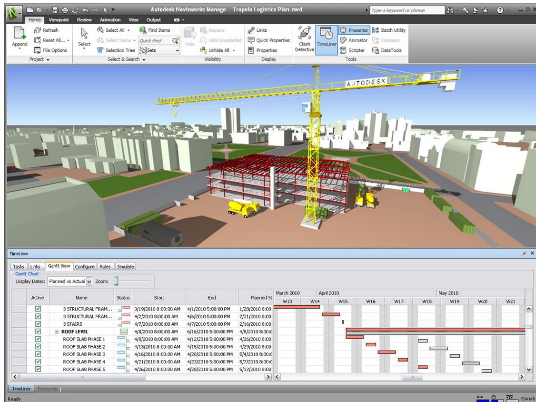
Figura 8: Exemplo de cronograma de obra no software NavisWorks.
