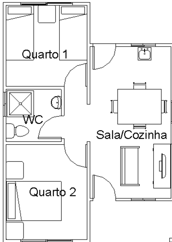
Figura 21: Planta baixa da casa com paredes de concreto moldadas in loco , modelada no Revit.
