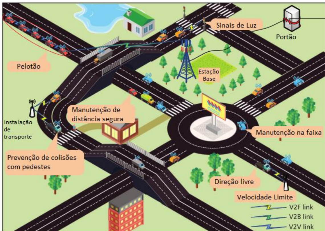
Figura 2.3: Infraestrutura necessária para um HetVNET para veículos autônomos.
