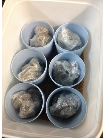
Figura 3.8 Pastas de cimento em uma caixa com sílica gel
