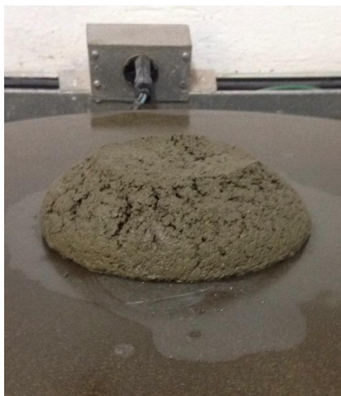
Figura 3.4 Argamassa de areia natural com uso de superplastificante
