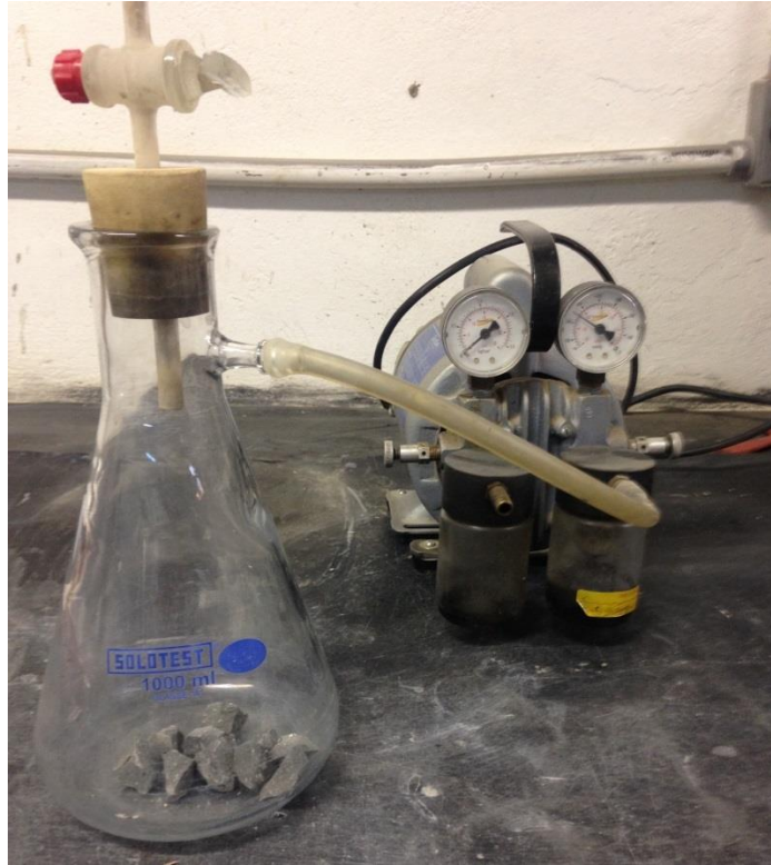
Figura 3.7 Pasta de cimento passando um tempo no “vácuo”.
