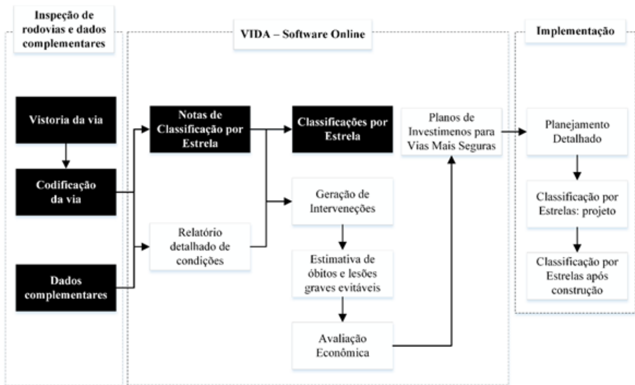
Figura 2.3 Processo de levantamento iRAP adaptado de iRAP (2016)
