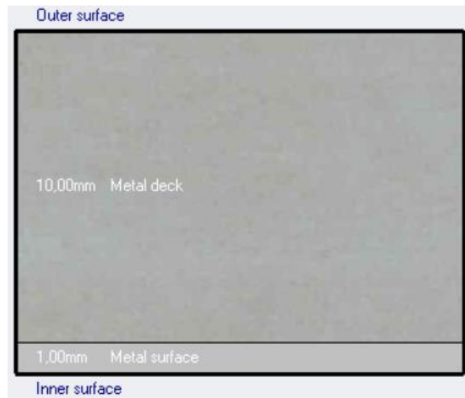
Figura 30 – Esquema de representação do material escolhido para o teto. FONTE: Design Builder EnergyPlus.
