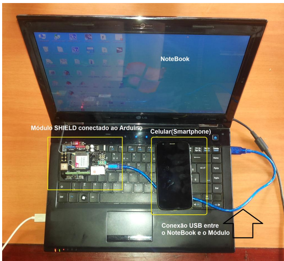
Figura 20: Esquema de Funcionamento da Coleta de dados GPS. Fonte: Autoria Própria.
