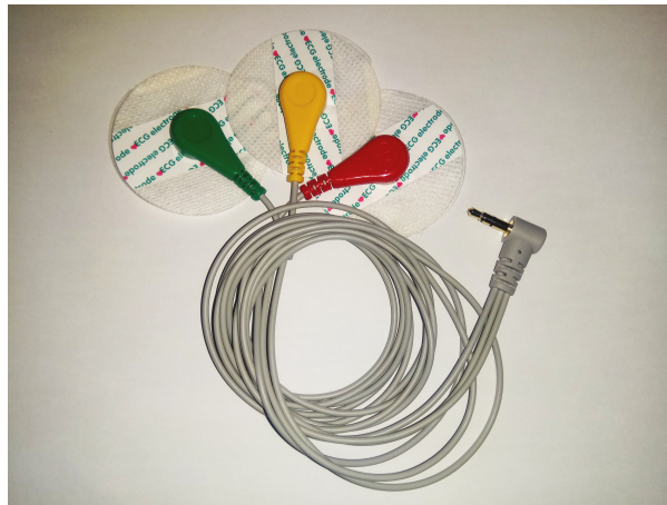
Figura 3.2. Sensores elétricos para aquisição do sinal de ECG
