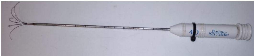
Figura 11 – Imagem do eletrodo guarda-chuva utilizado em dois experimentos com modelo de fígado bovino ex vivo . Do autor.
