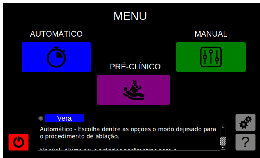
Figura 6 – Tela inicial - Menu. Essa tela permite escolher os modos de operação. O Modo Manual permite que o usuário escolha os parâmetros de operação de forma individual. O Modo Automático possui protocolos de operação definidos para que o médico escolha de acordo com a necessidade de operação. O Modo pré clínico contempla informações relevantes do paciente, para que o médico possa ter acesso, caso queira. Do autor.
