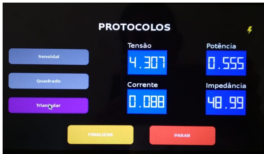
Figura 17 – Imagem da tela construída para o módulo de diferentes formas de ondas periódicas, chamado Protocolos. Ao selecionar a forma de onda para realizar o procedimento o push button clicado muda sua coloração para roxo. Os quadrados em azul apresentam o valor naquele momento da tensão (em volts), potência (em watts), corrente (em ampères) e impedância (em ohms). Do autor.
