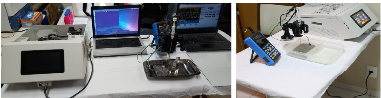
Figura 13 – Imagem da bancadas de testes experimentais, Bancada 1 e 2, respectivamente, para a validação do módulo Protocolos. As bancadas contém o osciloscópio, eletrodo, aparato para o eletrodo, placa de terra e equipamento ARF-SOFIA. Do autor.
