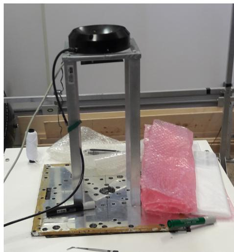
Figura 4 – Suporte para esfera do sistema de Rolamento de Ar - fonte: (SILVA, 2015)
