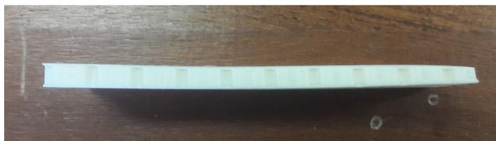
Figura 48 – Defeito de Fabricação do ABS: *Warping* - fonte: próprio autor
