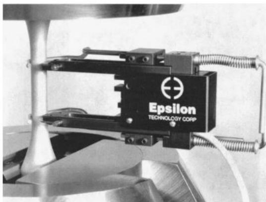
Figura 15 – Extensômetro - Instrumento utilizado para medir a deformação do corpo de prova - fonte: (DAVIS, 2004)
