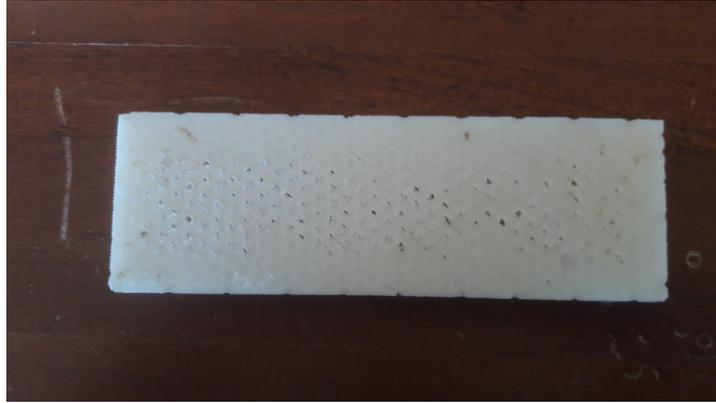
Figura 49 – Defeito de Fabricação do ABS: Falha de preenchimento - fonte: próprio autor
