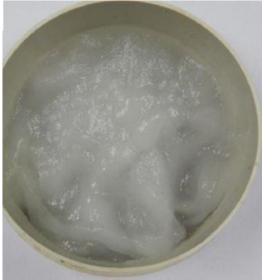
Figura 2: Gel Purificado com agente oxidativo clorado. (Fonte: VIEIRA, 2015)
