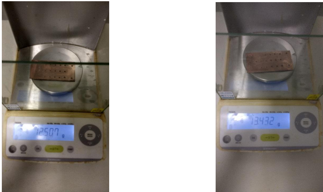
Figura 23: Peso da Placa 1 (à esquerda) e da Placa 2 (à direita) após aquecimento em forno ilustrando os passos 6 e 7
