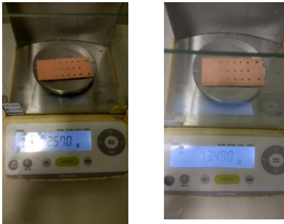
Figura 23: Peso da Placa 1 (à esquerda) e da Placa 2 (à direita) após aquecimento em forno ilustrando os passos 6 e 7
