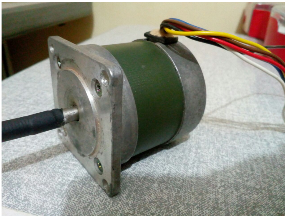
Figura 38 – Motor Tamagawa Ts3103n145.
