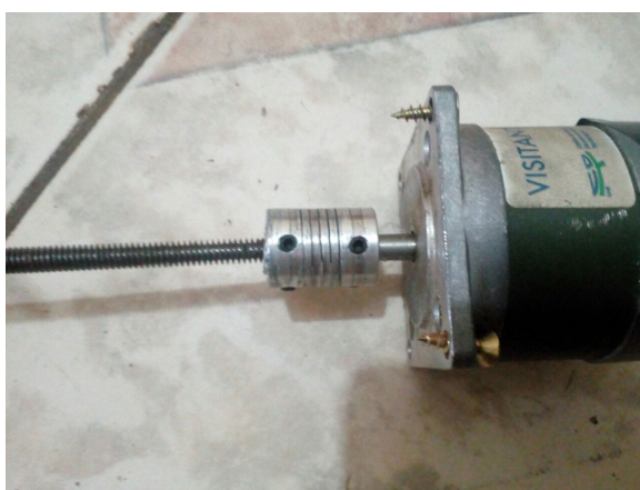
Figura 28 – Acoplamento entre o eixo do motor e a barra de transmissão.
