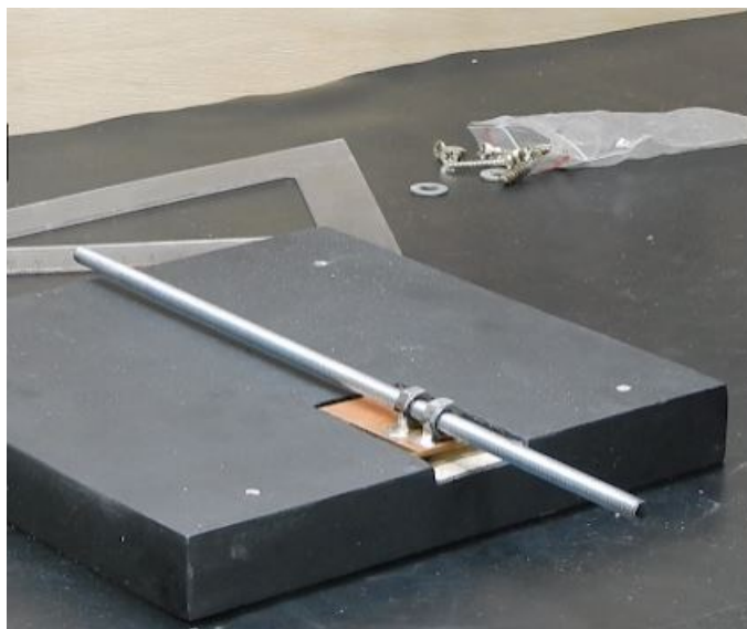
Figura 27 – Sistema de tração do eixo X. Fonte: (NARDI, 2014).
