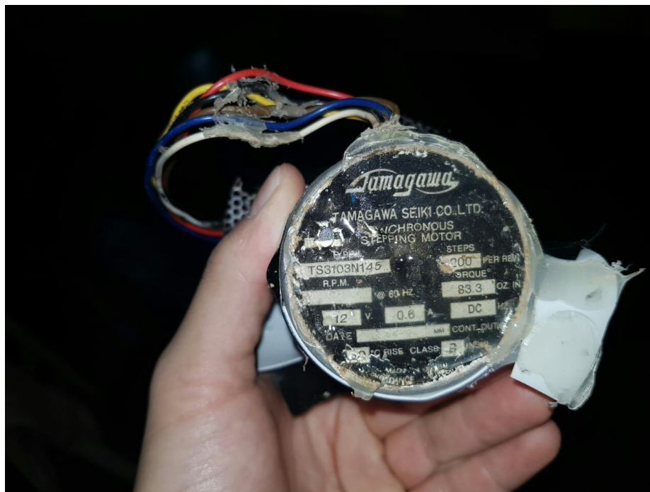
Figura 39 – Características de operação do motor Tamagawa Ts3103n145.
