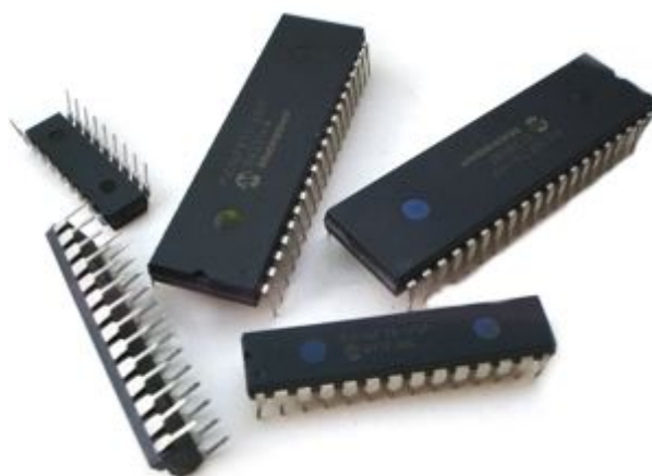
Figura 18 – Exemplos de microcontroladores. Fonte: (MICROCONTROLADORES, 2018).
