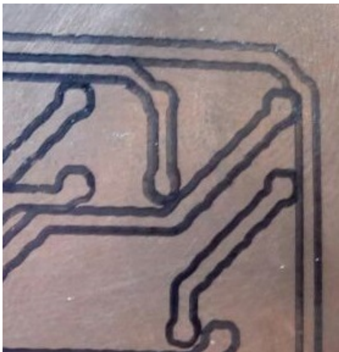
Figura 49 – Ondulações no desenho das trilhas.
