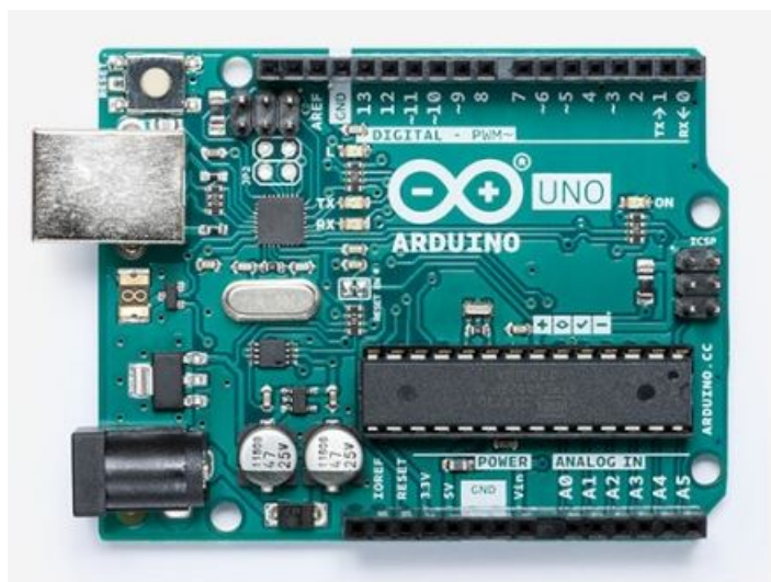
Figura 20 – Arduino UNO com ATmega 328. Fonte: (ARDUINO, 2018).
