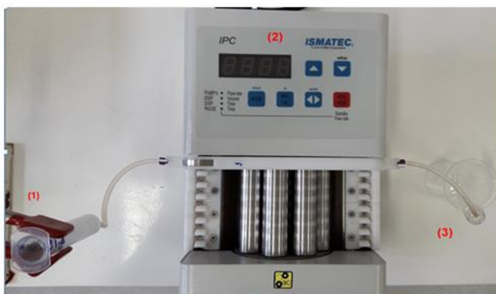
Figura 4: Instrumentação utilizada. Em (1) temos o suporte para o cartucho de SPE, em (2) temos a bomba peristáltica e em (3) temos a coleta do eluato que será analisado em HPLC ou em UV-VIS.
