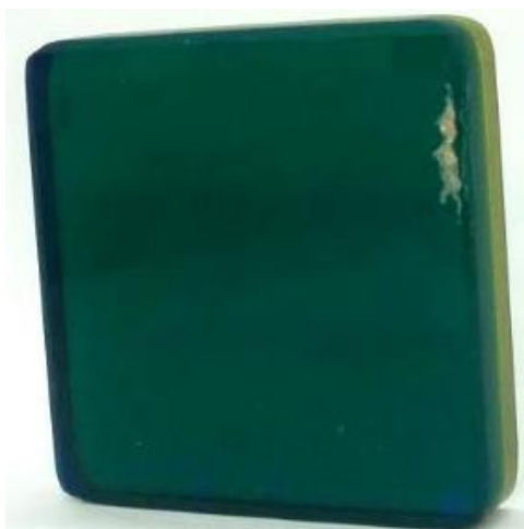
Figura 9: Filtro óptico de absorção utilizado na seleção do comprimento de onda da lâmpada fluorescente.
