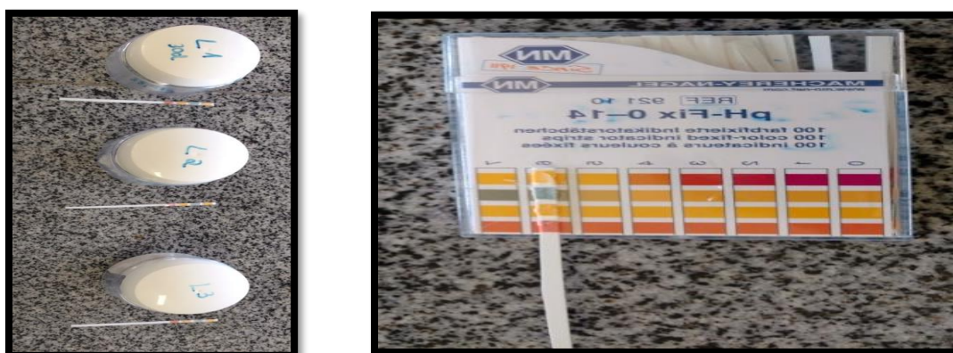
Figura 6. Fotografias ilustrativas da avaliação de pH realizada para o creme multifuncional para os pés submetido ao estudo de estabilidade preliminar em câmara climática a 40°C e 75% UR por 30 dias.
