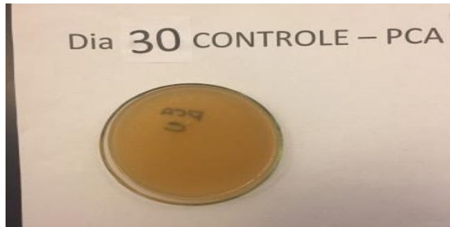
Figura 8 – Resultados das análises de contagem total de bactérias mesófilas nas amostras do creme analisadas 30 dias após exposição em câmara climática.
