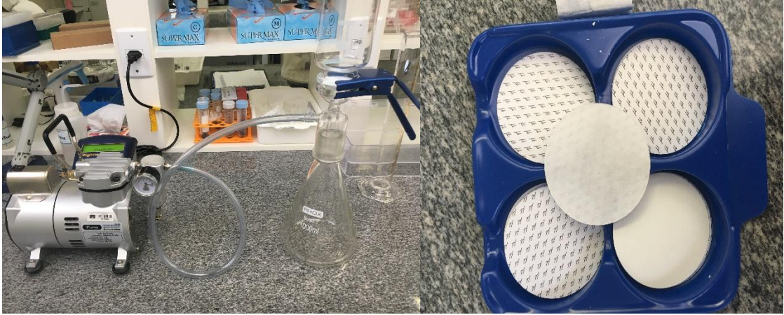
Figura 8. Sistema de filtração a vácuo composto por bomba de vácuo MaxPump 200w e conjunto de vidrarias Phox. Membrana de nylon Unifil 47mm de diâmetro e poros de 0,45 \mu m. Fonte: elaborado pelo autor.
