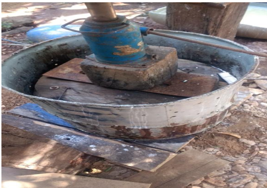
Fotografia 24 - Visão superior da prensa construída com macaco mecânico
