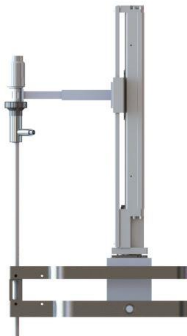
Figura 4.10: Interligação entre o endoscópio e o cursor do atuador linear.
