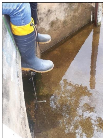
Figura 4.18 – Medição da velocidade do fluxo na saída da lagoa com molinete.
