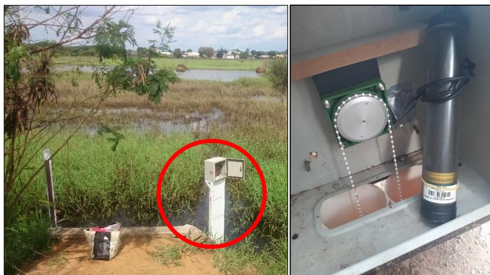
Figura 4.10 – Linígrafo de boia instalado na saída da lagoa.
