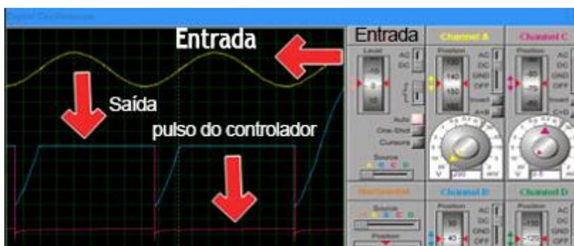
Figura 17 - Resultado da simulação dimmer microcontrolado.
