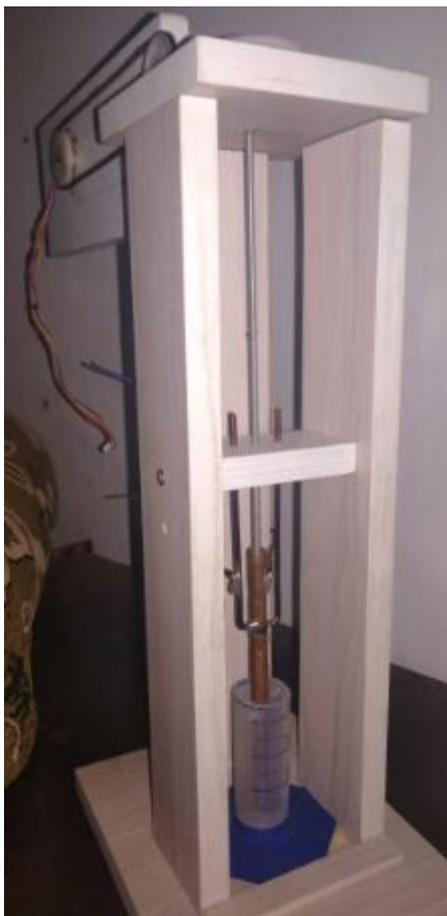
Figura 30 - Estrutura da máquina de ensaio de rigidez dielétrica.
