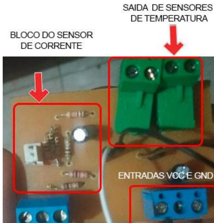
Figura 28 - Placa de circuito impresso do projeto finalizada
