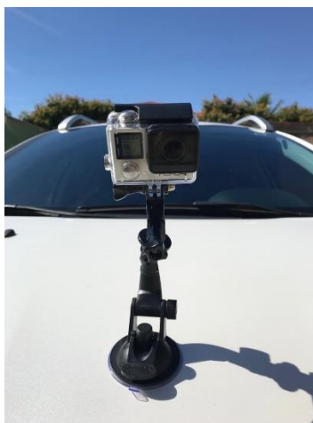
Figura 3.3 – Câmera GoPro instalada no veículo de avaliação
