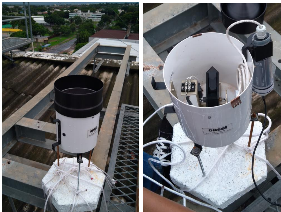
Figura 4.10. Pluviógrafo instalado no telhado do Centro Comercial em Cruzeiro Velho.
