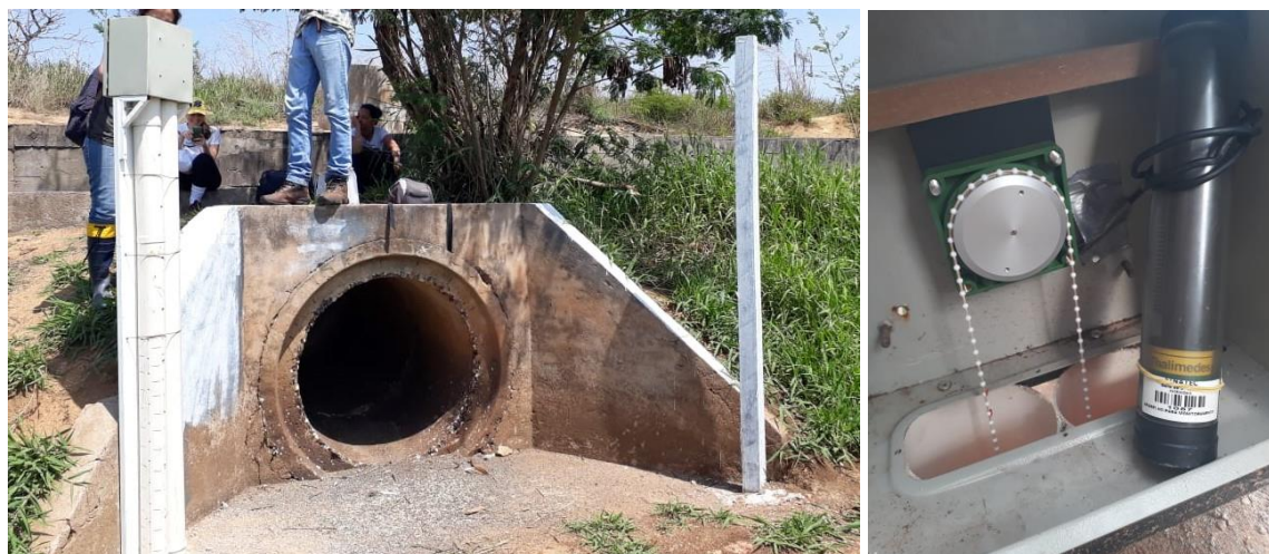
Figura 4.9. Linígrafo de boia e régua instalados na saída da lagoa (foto da esquerda), detalhes do linígrafo (foto da direita).
