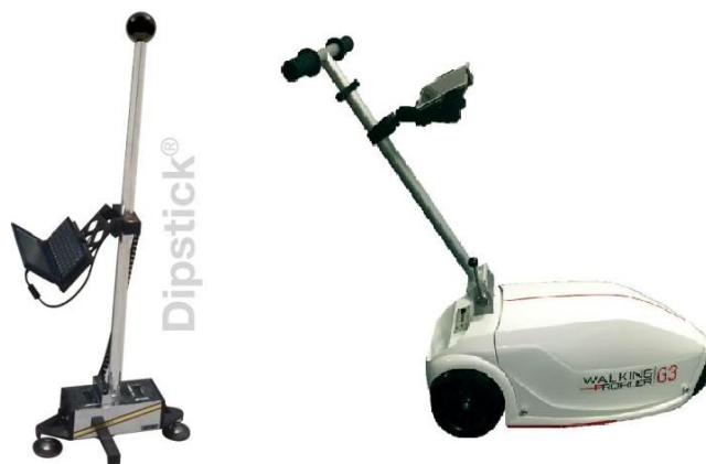
Figura 2.12– Dipstick a esquerda e Walking Profile a direita (Face Construction Technologies Inc, 2018) e (ARRB Group, 2018)
