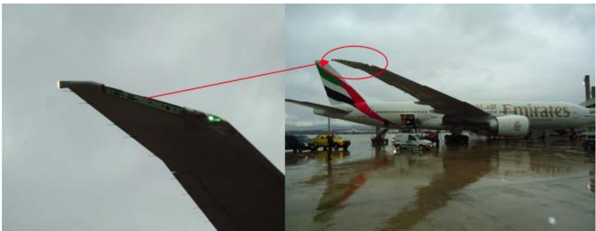
Figura 40: Danos estruturais na ponta da asa direita do Boeing 777 da Emirates. Fonte: CENIPA.
