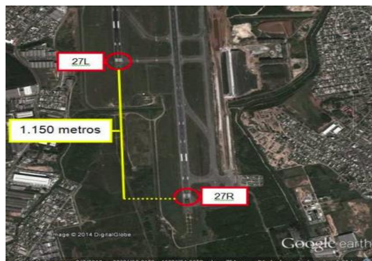
Figura 34: Diferença de recuo entre a pista 27L, onde o pouso deveria ter ocorrido, e a 27R, onde ocorreu. Fonte: CENIPA.
