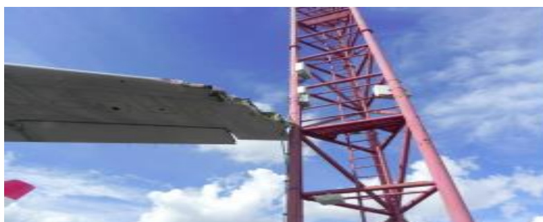
Figura 37: Danos na ponta da asa esquerda por choque com poste de iluminação do pátio. Fonte: CENIPA
