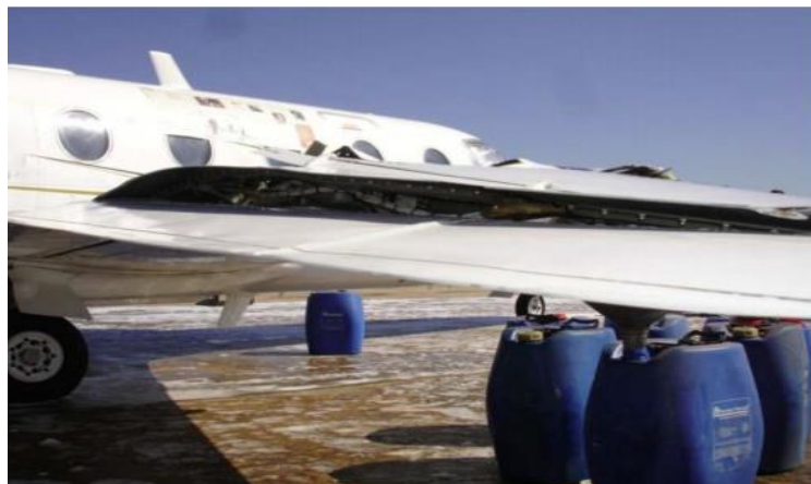
Figura 44: Danos na asa direita após acidente. Fonte: CENIPA.
