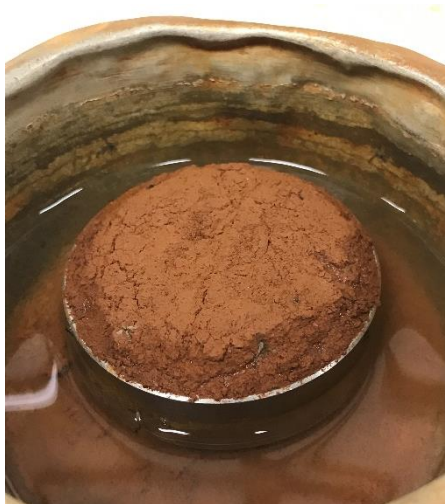
Figura 4.7 – Amostra de mistura de solo com bentonita sódica e tensoativo fissurada.
