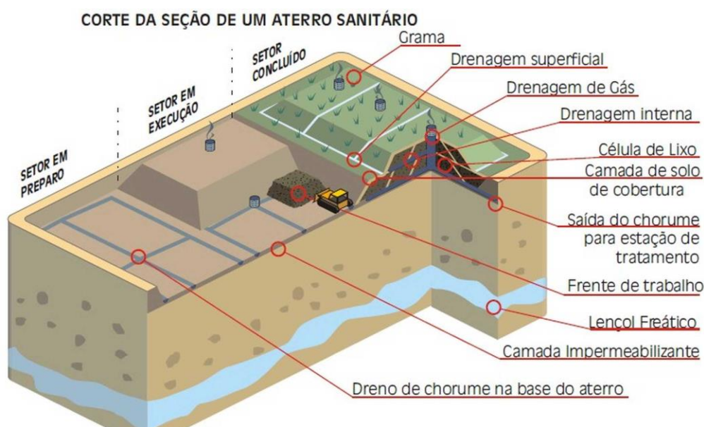
Figura 2.7 – Representação de um aterro sanitário (Manual do Governo do Estado da Bahia).
