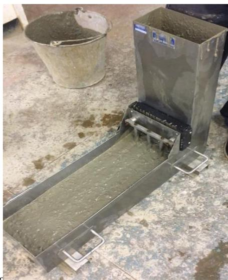
Figura 3.4: Ensaio de Caixa L em execução (Fonte: acervo pessoal).
