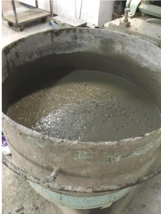
Figura 3.3: Aspecto do traço de referência de Concreto Autoadensável (Fonte: acervo pessoal).
