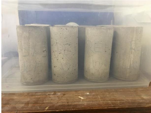
Figura 3.6: Corpos de prova durante ensaio de absorção de água por capilaridade (Fonte: acervo pessoal).
