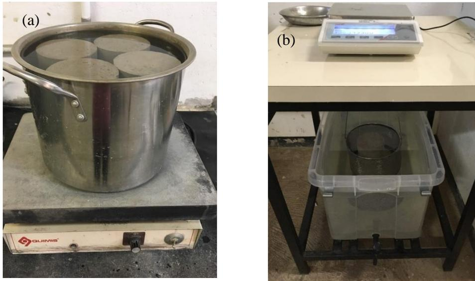
Figura 3.5 (a): Corpos de prova em processo de ebulição (Fonte: acervo pessoal) e (b) Pesagem de corpo de prova em balança hidrostática (Fonte: acervo pessoal).
