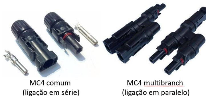
Figura 26 - Conectores MC4 para ligação de módulos fotovoltaicos
